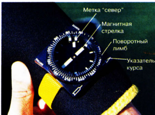
Основные элементы подводного компаса.
