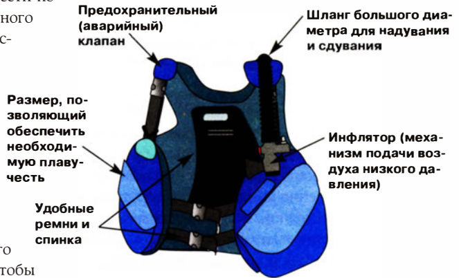
Конструктивные особенности компенсатора плавучести (BCD)
